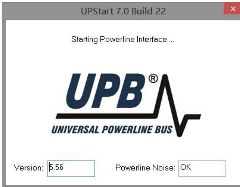
此页显示设备版本，电脑连接 UPB 双向电力载波通讯接口(RS232)成功。
